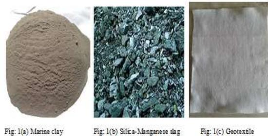
Fig: 1(a) Marine clay Fig: 1(b) Silica-Manganese slag Fig: 1(c) Geotextile
